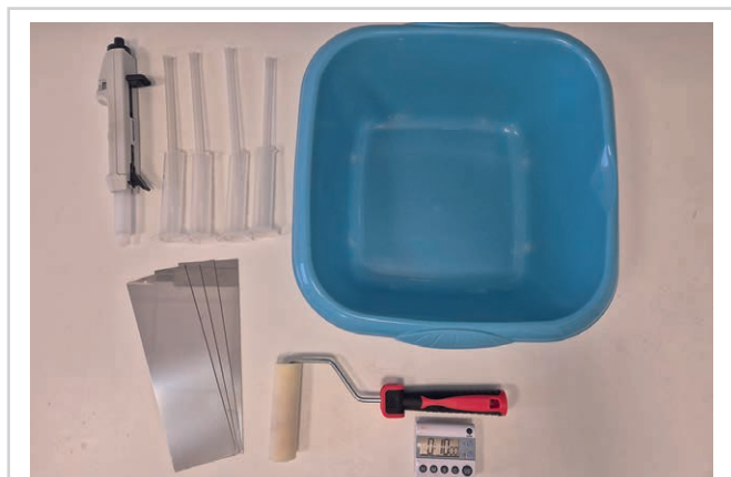
Abb. 2 Auszug der Gegenstände für die Prüfmethode: Edelstahlplatten, Pipette, Spritzen, Farbroller, Stoppuhr und Kunststoffwanne.
