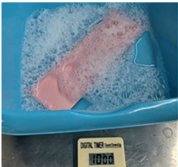
Abb. 6 Einweichen einer angeschmutzten Edelstahlplatte in der Einweichlösung für 10 Minuten.
