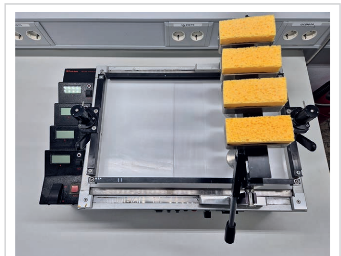
Abb. 1 Mehrspurenwischgerät mit Schwammhalterung, hier gezeigt das Modell Sheen PG 903, zur Verwendung von Wisch- bzw. Scheuerversuchen.
